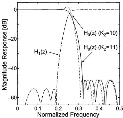
図 8 設計例 3 の分解フィルタの振幅特性
