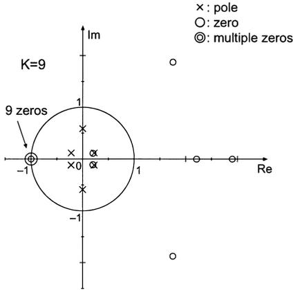
図 7 設計例 2 の最大平坦 IIR ハーフバンドフィルタの極零点配置
