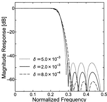
図 3 設計例 1 の IIR ハーフバンドフィルタの振幅特性
