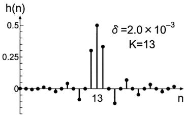
図 2 設計例 1 の IIR ハーフバンドフィルタのインパルス応答
