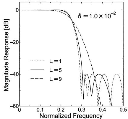
図 5 設計例 2 の IIR ハーフバンドフィルタの振幅特性
