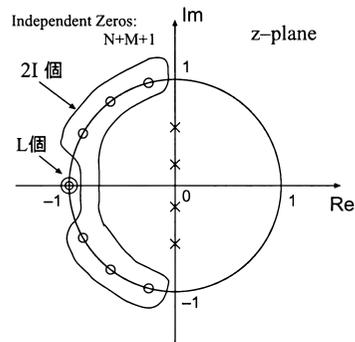
図 1 IIR ハーフバンドフィルタの極零点配置
